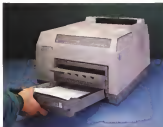
La stampante Laser Atan accetta fogli A4 del formato di alimentazione e manualmente
